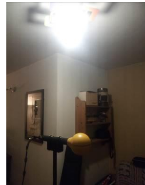
Figure 5-4: niveau de champ magnétique dans la bande de fréquences utilisée pour le CPL Linky Mesure dans un logement, sous une lampe à LED 13W (distance : 65 cm)
