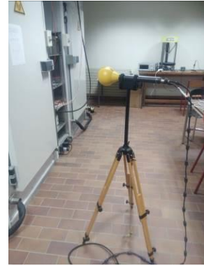
Figure 5-2: niveau de champ magnétique dans la bande de fréquences utilisée pour le CPL Linky Mesure dans un laboratoire éclairé par des tubes fluorescents à ballast électronique
