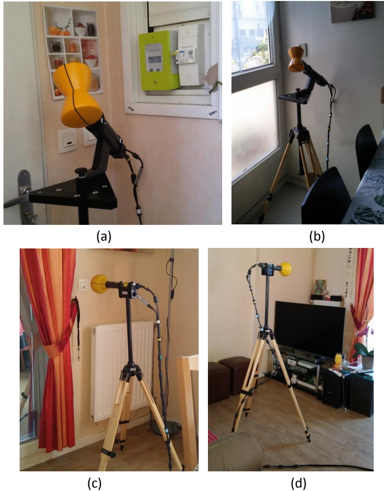
Figure 12 : points de mesure dans un appartement équipé d'un compteur Linky (a) en face du compteur installé dans la cuisine, (b) en face d'une prise électrique de la cuisine, (c) en face d'un interrupteur du salon, (d) au milieu du salon
