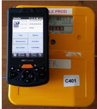
Figure 4 : PDA de maintenance qui permet de déclencher la transmission des trames
