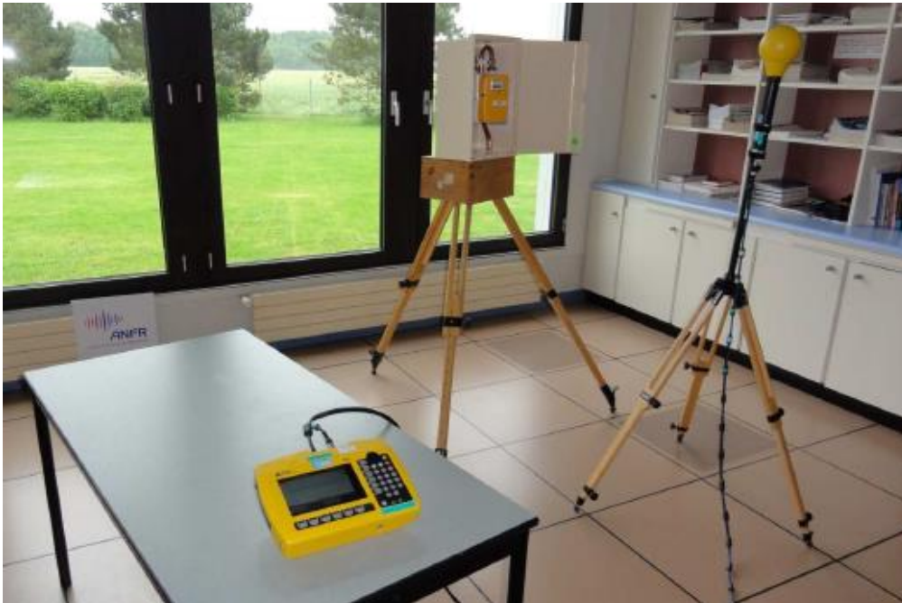
Figure 11 : configuration de la mesure COFRAC sur le compteur n°8
