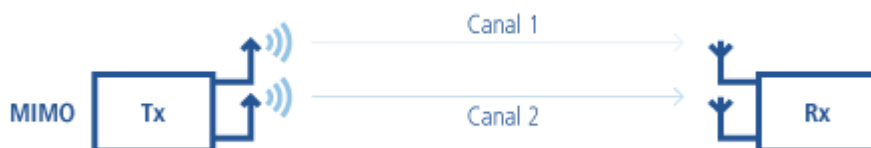
Figure 67 : Principe du MIMO
