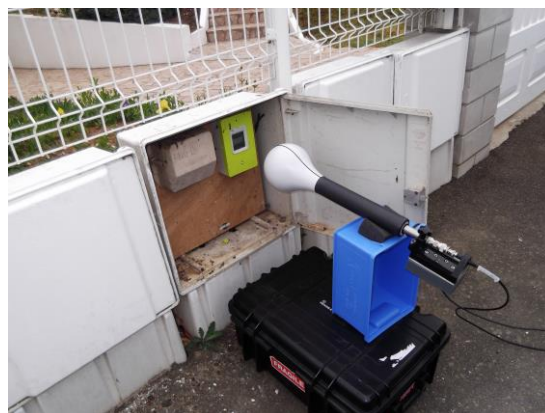
Photo 12. Champ électrique sur site - Antenne E isotropique
