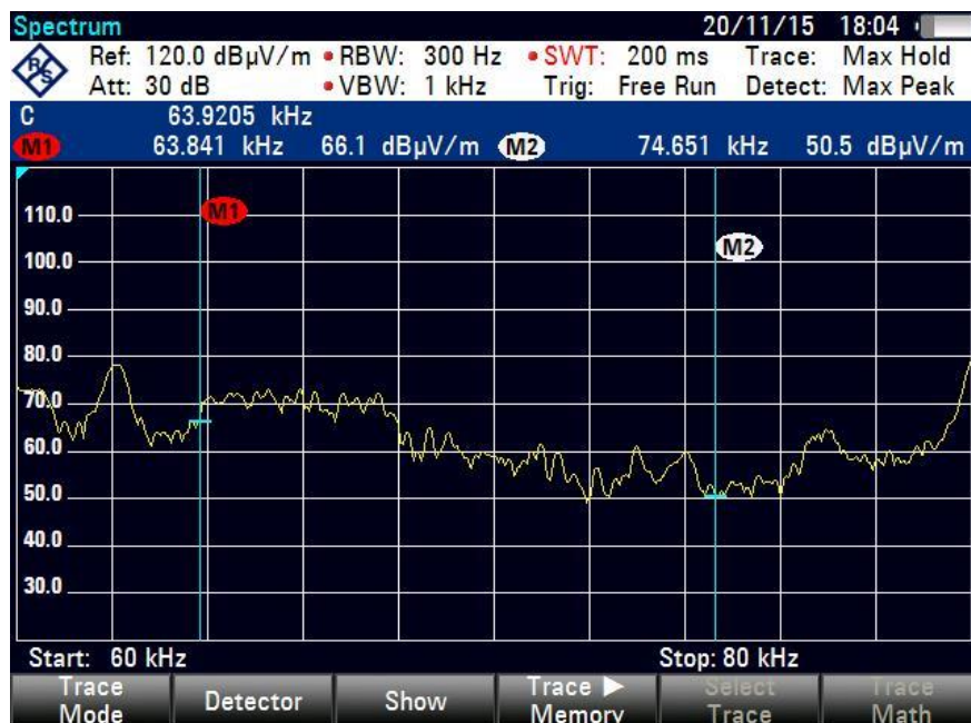
Figure 2. Hors tension, les signaux CPL ne sont pas visibles
